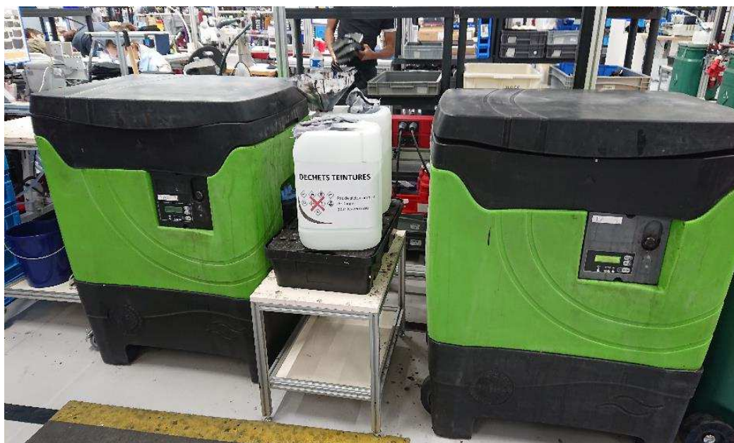
Figure 20 : Fontaines de nettoyage des outils d'application de teintures et colles
